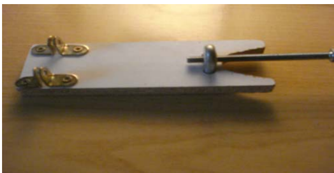
Figura 4: Dispositiu per immobilitzar l'èmbol de manera que la reacció transcorri a volum constant
